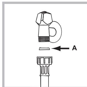
2. Вставьте прокладку A в конец водопроводного шланга и привинтите его к водопроводному крану холодной воды с резьбовым отверстием 3/4 дюйма (см. схему). Перед подсоединением откройте водопроводный кран до тех пор, пока из него не потечет чистая вода.
